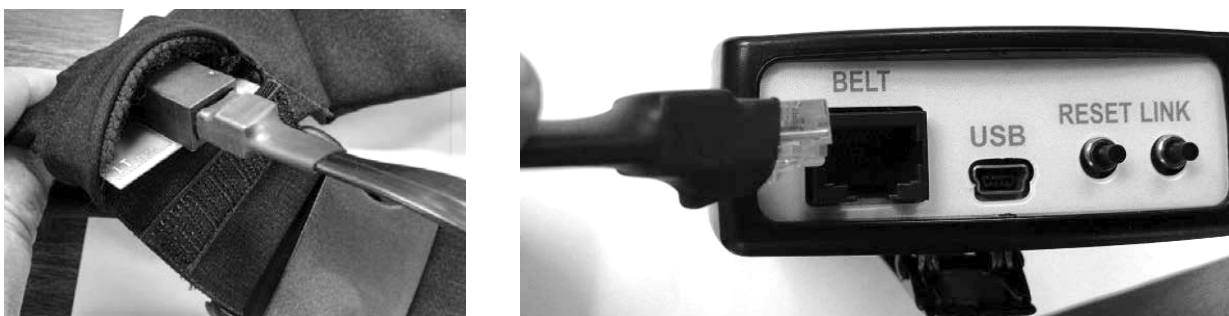
Figura 8.4. Collegamento del ricevitore tattile alla cintura.
