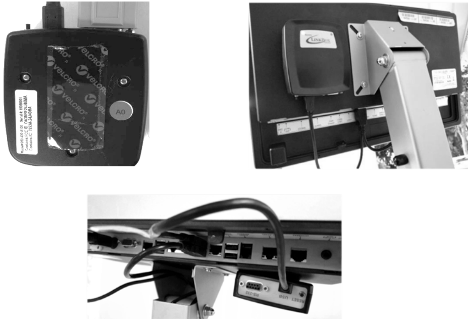
Figura 8.3. Installazione della centralina di collegamento sul retro del display.
