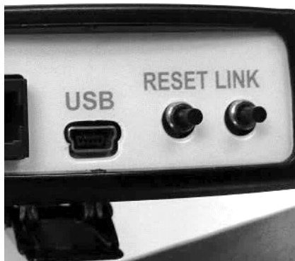
Figura 8.12. Toccare LINK per eseguire il collegamento wireless con il ricevitore della cintura tattile.
