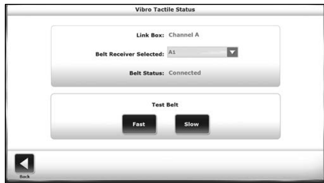
Figura 8.12. Toccare LINK per eseguire il collegamento wireless con il ricevitore della cintura tattile.
