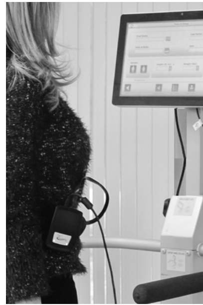
Figura 8.8. I ricevitori della cintura tattile possono essere caricati mediante un collegamento a una presa a parete o al display del dispositivo.
