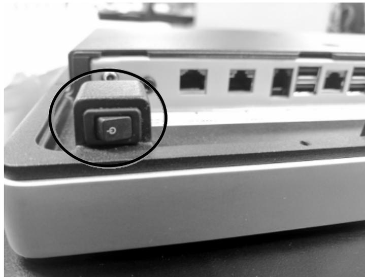
Abbildung 2.3. Netzschalter auf dem Display.
