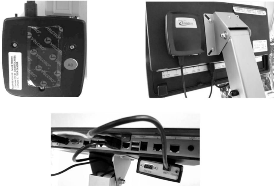
Abbildung 8.3. Installation der Link-Box auf der Rückseite des Displays.
