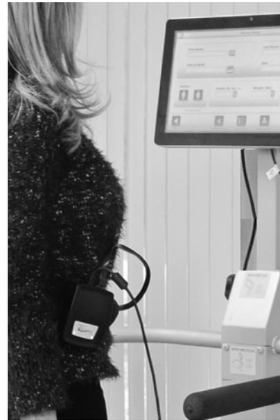
Abbildung 8.8. Die Boxen des taktilen Gurtaufnehmers können mit einer Verbindung zu einer Steckdose oder zum Display auf dem Gerät aufgeladen werden.
