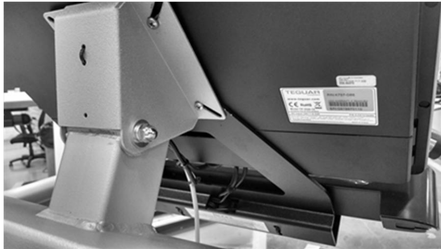
Figura 8.1. El soporte de montaje de la barra de sonido se desliza detrás del soporte de la pantalla del Gait Trainer y se fija con los dos tornillos del mismo.
