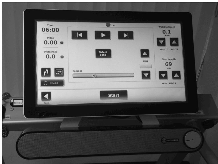
Abbildung 11.1. Display des Gait Trainers mit installierter Musiktherapie-Soundleiste.
