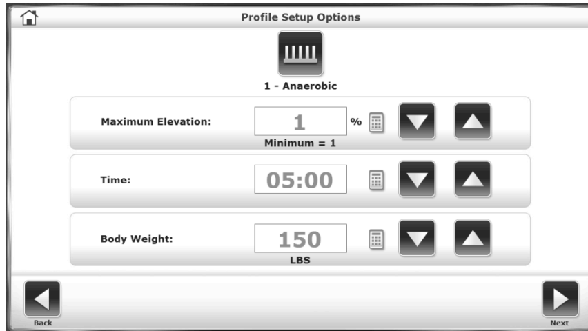
Abbildung 6.2. Vom Bildschirm Profile Setup Options (Profilinrichtungsoptionen) aus können Benutzer Werte für Time (Zeit), Body Weight (Körpergewicht) und Maximum Elevation (Maximale Steigung) eingeben.
