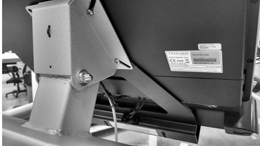
Abbildung 11.2. Die Montagehalterung der Soundleiste wird hinter der Displayhalterung des Gait Trainers eingeschoben und mit den beiden Schrauben der Displayhalterung des Gait Trainers befestigt.
