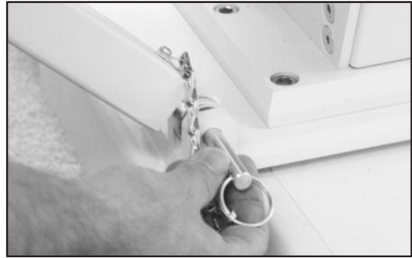
Abbildung 2.5. Befestigung der Rückenlehnenstrebe in Gabel am Wagen System 4.
