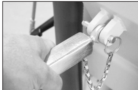
Abbildung 2.4. Befestigung der Rückenlehnenstrebe mit Gabelbolzen System 4.
